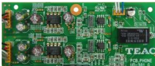
La sortie casque utilise des amplificateurs opérationnels NJM4580 fabriqués par JRC et ils sont utilisés sans le moindre condensateur de liaison afin de préserver la qualité sonore en
