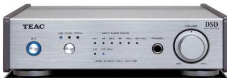
On trouve à gauche de la façade le bouton de mise en marche ceint d'une couronne bleue qui s'éclaire sous tension, suivi du sélecteur d'entrée numérique, lequel est surmonté de trois LED témoins. Puis viennent deux autres rangées de LED, l'une étant affectée aux fréquences d'échantillonnage des signaux PCM, l'autre aux signaux DSD avec deux indications, 2,8 et 5,6 MHz.
