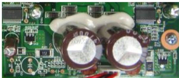
**Les entrées S/PDIF** sont prises en charge par un récepteur numérique Cirrus Logic CS8422 qui commute les entrées coaxiale et optique et intègre également un convertisseur de taux d'échantillonnage (SRC) que l'on pourra utiliser ou non, et ce également avec les signaux PCM en provenance de l'entrée USB.
