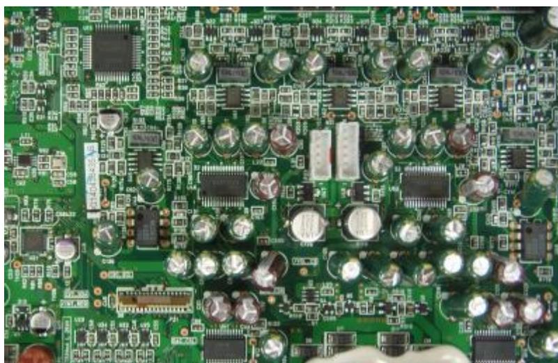
Le nettoyage des signaux est ensuite réalisé par des filtres construits autour d'amplificateurs opérationnels doubles N5532 d'origine Texas Instruments, puis ce sont des potentiomètres électroniques quadruples NJW1195A de JRC qui règlent leur volume avant qu'ils soient envoyés, d'une part vers les sorties ligne symétriques et asymétriques au travers de trois amplificateurs opérationnels doubles N5532 et vers le circuit où se trouvent les amplificateurs pour casque.
