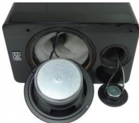
La surface de la membrane en pulpe de cellulose de 13 cm de diamètre du haut-parleur de grave-médium est enduite d'un matériau amortissant et n'est pas équipée d'un cache noyau central mais d'une couronne absorbante annulaire en mousse, ceci afin de munir les pièces polaires de ce haut-parleur d'une ogive de refroidissement en aluminium. L'aimant en ferrite de ce haut-parleur présente un diamètre de 9 cm, ce qui est confortable et devrait lui procurer de la vivacité.
