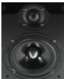
Le tweeter est un modèle à dôme en tissu traité de 25 mm de diamètre dont l'aimant compact est réalisé en Néodyme, un matériau permettant d'obtenir des champs magnétiques puissants sous de faibles dimensions. Le rendement et la dispersion spatiale de ce tweeter se voient améliorés par une amorce de pavillon ménagée sur sa pièce frontale.
